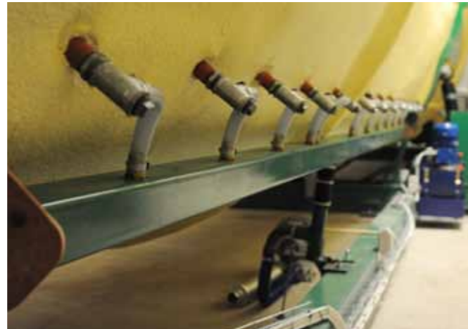
Luft trycks in i komposten med hjälp av en fläkt
