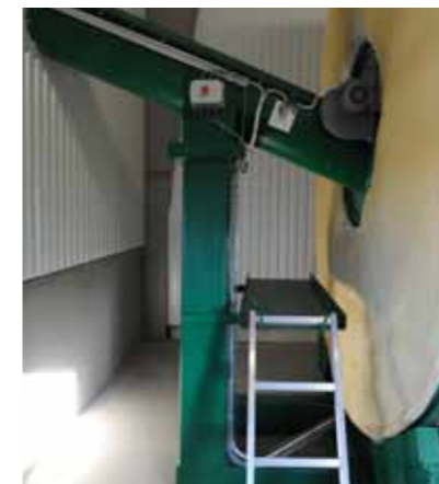
In- och utmatning sker från centrum av trumman, som invändigt är behandlad med flera lager speciellack för att stå emot korrosion
