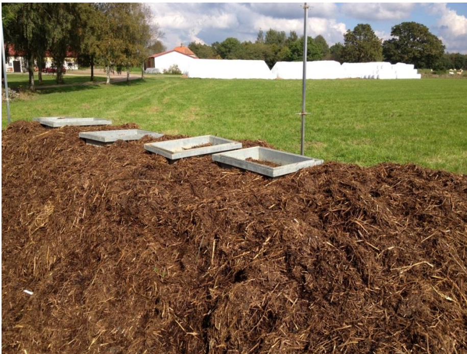
Figur 22. Förkompost med ramar för slutna kamrar (gasmätning växthusgaser) samt master med fluxprovtagare för mätning av ammoniakavgång, Mellby gård.
