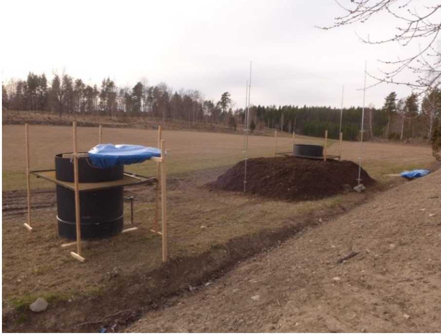
Figur 19. Efterkompost A (bortre hög) upplagd och omgiven av master för mätning av \text{NH}_3 -emissioner. I förgrunden syns cylinder, som är till för att mäta växthusgaser. Cylindern fylldes och omslöts av kompost vid uppläggning av kompost B.
