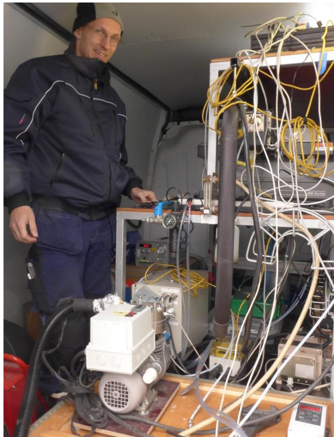
Figur 15. Emissionsmätutrustning inuti skåpbilen.
