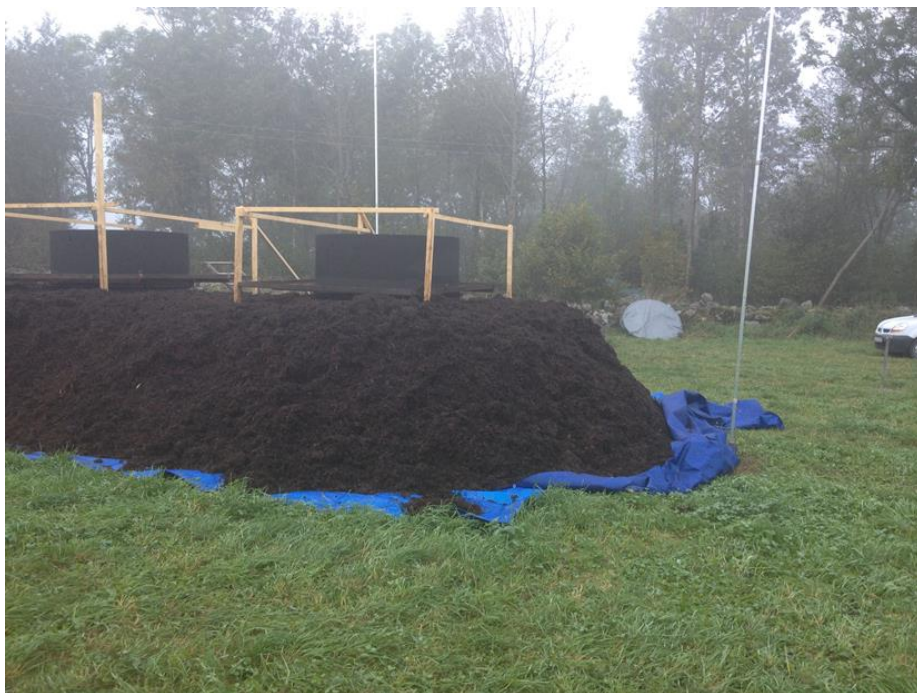
Figur 23. Efterkompost med cylindrar utan och med plastduktäckning för slutna kamrar (gasmätning växthusgaser) samt master med fluxprovtagare för mätning av ammoniakavgång, Mellby gård.
