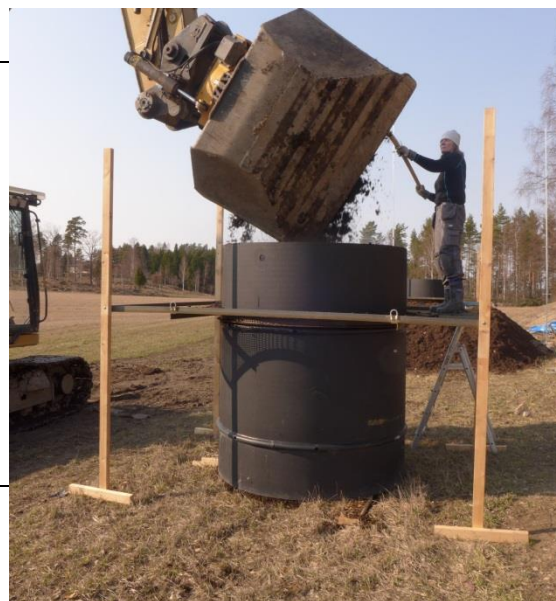
Enskild cylinder som bäddas in i högen, från vilken växthusgaser bestäms.
