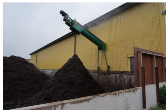
d) Utmatningsskriv från trumkomposten. I bakgrunden ses en del av efterkomposten.
