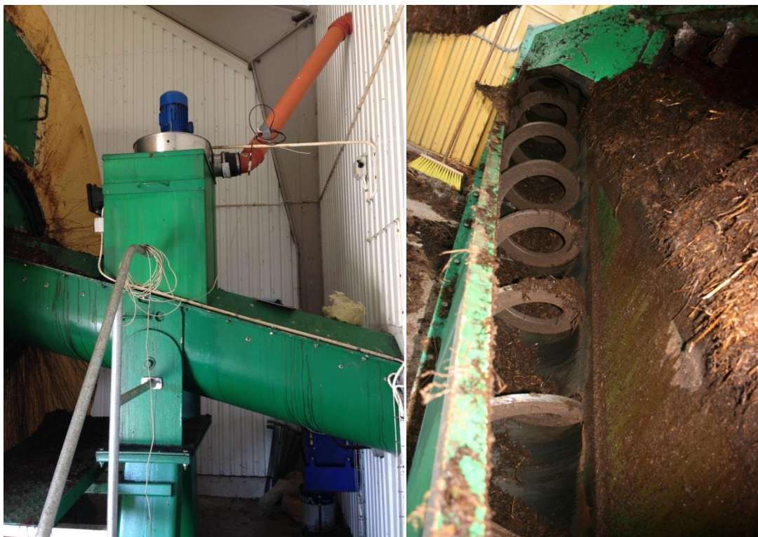
Figur 47. Vänster ) Inmatning av kompost inuti det gröna tråget, flöde från höger till vänster. Gasutsuget sker ovanför inmatningen med en radialfläkt (blå motor i fotot) till det tegelröda utloppsroret. Höger ) Inmatningsskruv, utanför byggnaden. Skruven löper inuti det gröna tråget nästan hela vägen fram till trumkomposten. Matningsbingen till höger i fotot. Material tillförs skruven med hjälp av skrapor i botten av bingen. När inte skruven är fylld med material kan luft gå till utloppsfläkten bakvägen.
