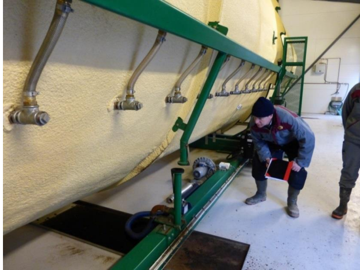
Figur 8. Extra luftinsläpp kopplas till trumman inför den stillastående fasen.
