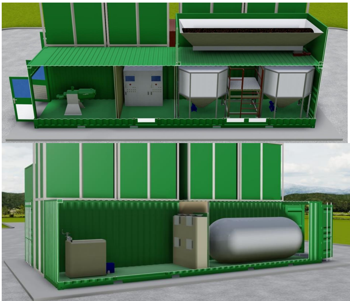
Denna anläggning hanterar 4 ton/dag matavfall (sallad, kryddor, rotfrukter mm)
