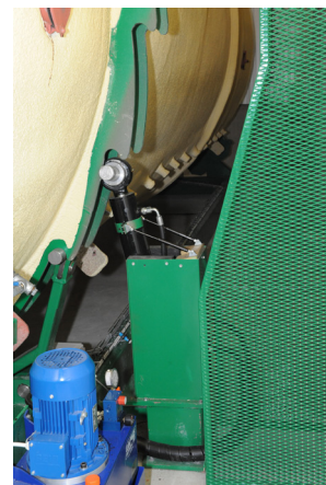
Rotationen drivs av energieffektiv hydraulik
