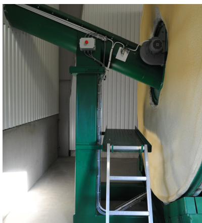
In- och utmatning sker från centrum av trumman, som invändigt är behandlad med flera lager speciallack för att stå emot korrosion
